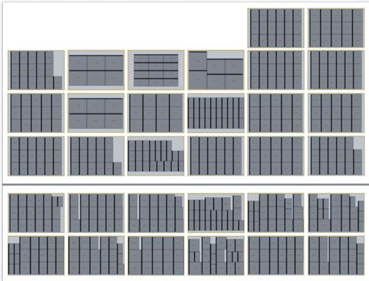
Das Bild zeigt die Druckformen des Jobpools mit 171 Druckbestellungen – oben mit herkömmlichem Formenbau, unten die von sPrint One berechneten Formen.
